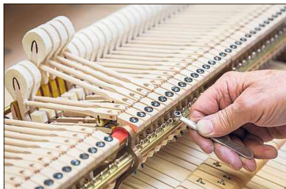
Das Regulieren einer Flügelmechanik zeigt dieses Detailfoto.
